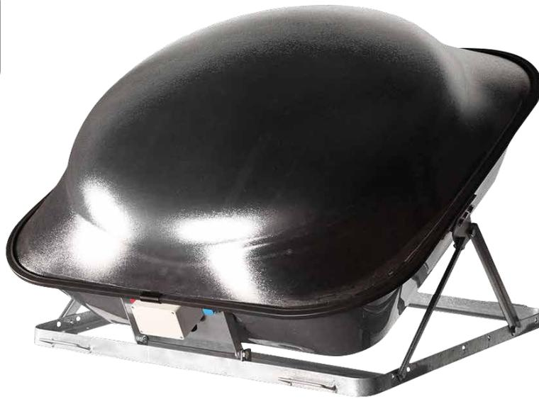
SUNBUSTER è un pannello solare che non richiede sofisticati impianti, ma che con una semplice e rapida installazione, fornisce acqua calda istantanea grazie al serbatoio di accumulo incorporato con capacità di ben 200 litri. Ha una superficie captante di circa 1 m<sup>2</sup> e può essere agevolmente installato su qualsiasi superficie grazie al telaio regolabile fornito di serie.
