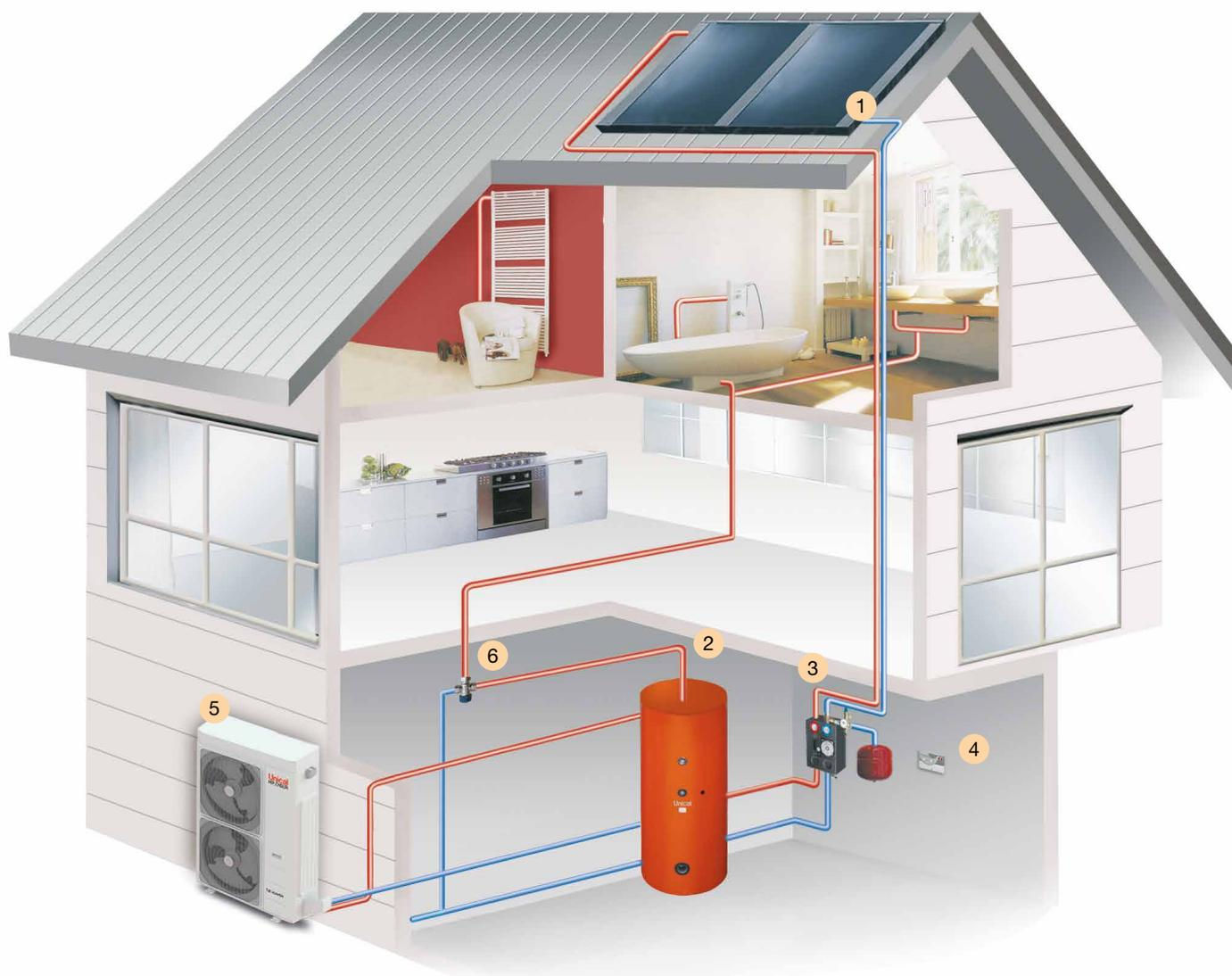
Lo schema propone, a titolo esemplificativo, un possibile impianto per la produzione di A.C.S. con pannelli solari termici.
