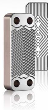
**Scambiatore sanitario** in acciaio inox a piastre saldobrasate. Perfettamente dimensionato assicura 13,3 l/min. con  $\Delta t$  25K
