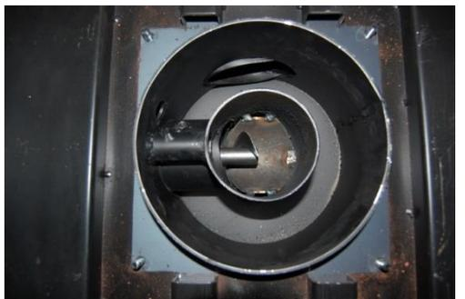
La valvola stellare, il motoriduttore della stessa e quello della coclea sono già montati. Controllare che il condotto dell'aria e la ventola siano montati sul lato più comodo (di fabbrica sul lato destro). Se possibile sigillare la ventola con del silicone. Collegare l'apposito tubo da 25Ø sia sul condotto aria ventola che sul tubo coclea e fissarlo con le fascette. Collegare anche il tubo da 60Ø e fissarlo, sempre al condotto aria.
