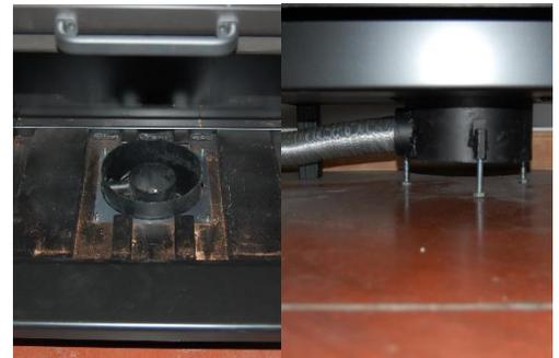
Inserire la spirale e farla uscire nel bruciatore. Fermarsi un po' prima della metà del cerchio centrale. Fissare il tubo coclea con l'apposito bullone. Assicurarsi che l'asse della spirale sia bloccata con gli appositi grani nel cuscinetto.
