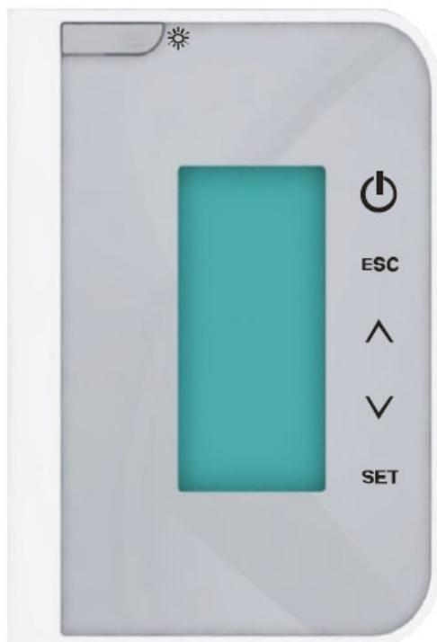
Il radiocomando svolge il ruolo di terminale wireless per il termoregolatore a cui è associato e tramite esso è possibile gestire e monitorare il funzionamento del sistema in tempo reale.
