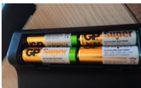
Sostituire tutte le batterie, facendo attenzione alla polarità.
