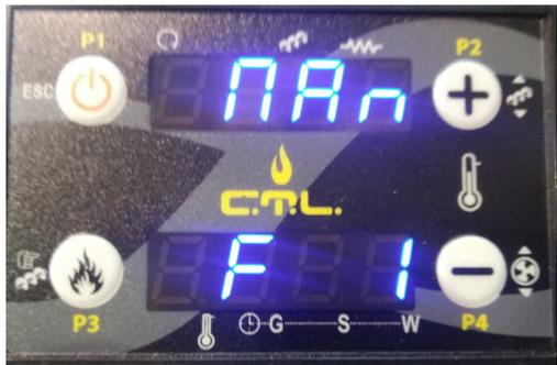
Se viene scelta la modalità manuale si apre la finestra di scelta sul display inferiore; modificare il valore con i tasti P2 e P4 (si possono scegliere tra cinque diverse velocità).
