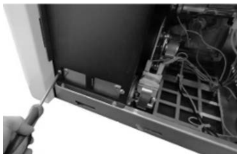
Fig. 80 - Pulizia ventilatore ambiente
