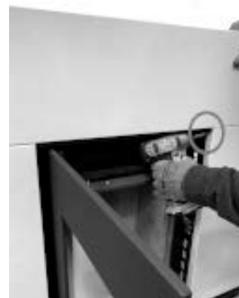
Fig. 44 - Fissare pannello superiore
