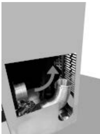
Fig. 99 - Ruotare il tubo flessibile
