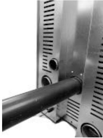
Fig. 67 - Collagare il tubo di scarico
