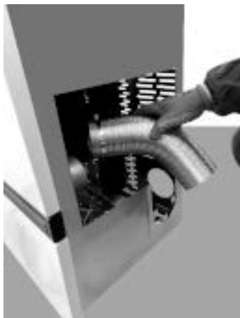
Fig. 96 - Togliere il tubo flessibile
