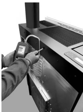
Fig. 110 - Collegamento pressostato digitale (Mithos 3 Plus12/14)
