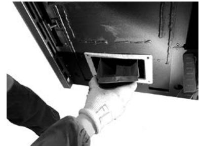
Fig. 128 - Rimuovere il deviatore fumi
