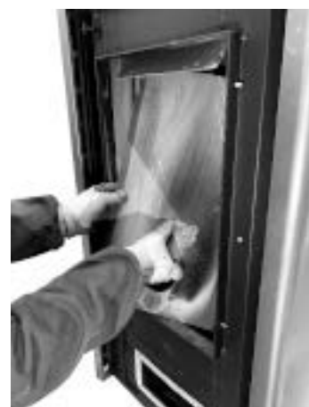
Fig. 123 - Rimuovere la schiena del focolare
