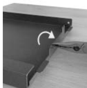
Fig. 38 - Piegare le linguette verso l'eterno
