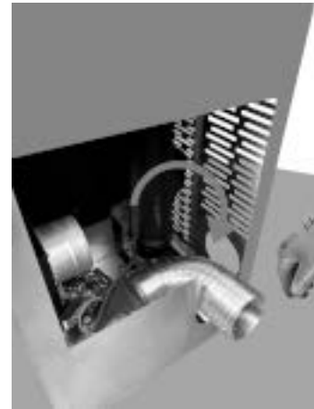
Fig. 92 - Ruotare il tubo flessibile
