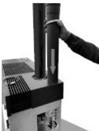
Fig. 101 - Inserire il tubo canalizzazione
