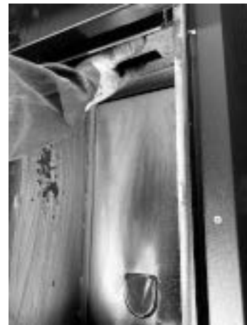
Fig. 120 - Rimuovere la testa del focolare 1
