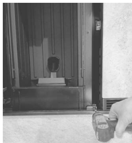
Fig. 64 - avvitare sulle alette
