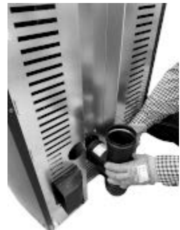
Fig. 70 - Collegare raccordo a T
