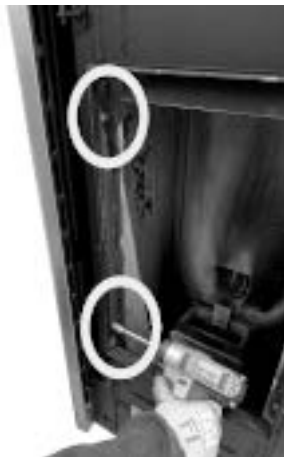
Fig. 119 - Rimuovere viti esagonali
