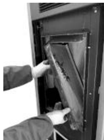
Fig. 80 - Rimuovere le pareti laterali
