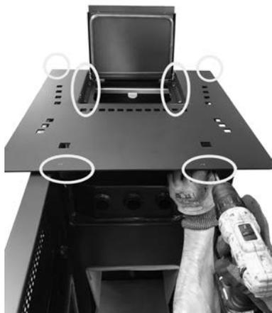
**Fig. 58 - Rimozione viti**
