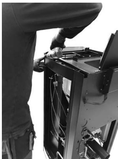
**Fig. 53 - Rimozione compensatore**
