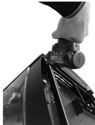
**Fig. 57 - Fissare il compensatore**
