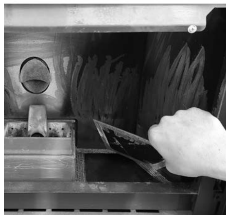
Fig. 99 - Rimuovere tappo ispezione
