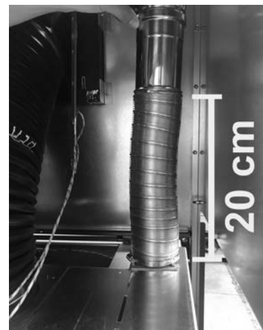
Fig. 45 - Collegamento tubo flessibile (vista posteriore dell'inserto)
