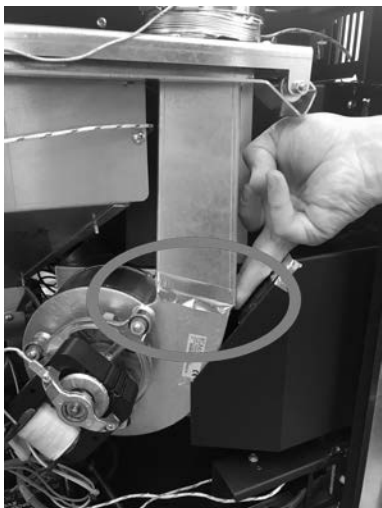
Fig. 43 - Sigillare con nastro adesivo in alluminio
