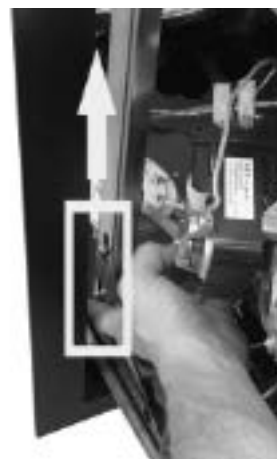
Fig. 19 - Sollevare piastrina di bloccaggio
