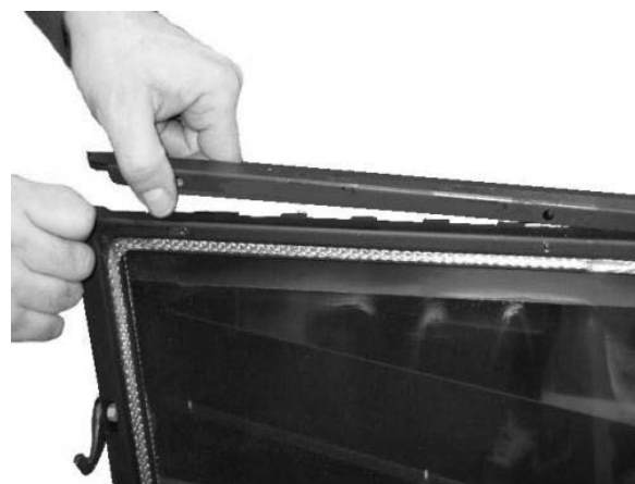
Fig. 113 - Rimozione profili porta
