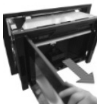
Fig. 20 - Estrazione corpo macchina
