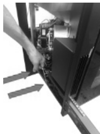
Fig. 24 - Rimozione corpo macchina
