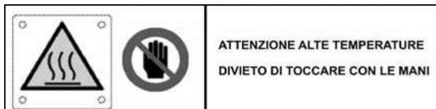
Fig. 2 - Etichette di sicurezza installate sull'apparato
