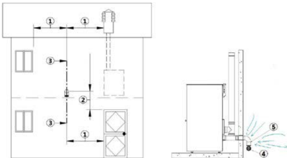
Fig. 7 - Presa d'aria per installazione a camera stagna
