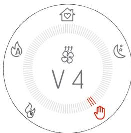
Grazie al tasto
