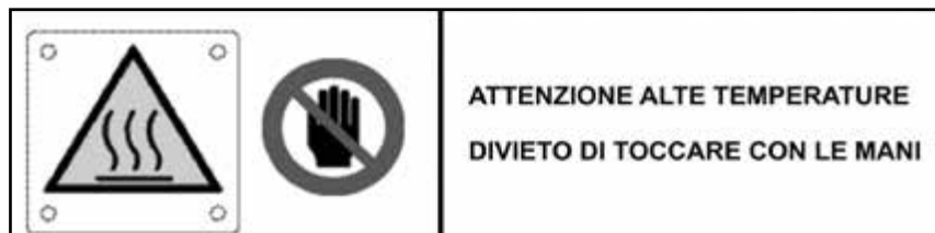
Fig. 2 - Etichette di sicurezza installate sull'apparato
