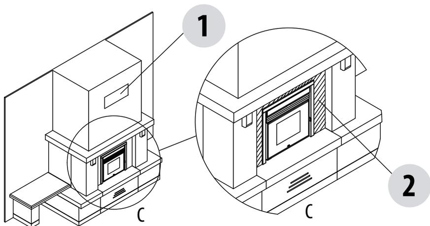
1 - è ammessa una griglia per lo sfogo dell'aria calda accumulata nella parte superiore del prodotto
