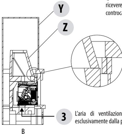
3 L'aria di ventilazione "3" deve provenire esclusivamente dalla parte inferiore.
