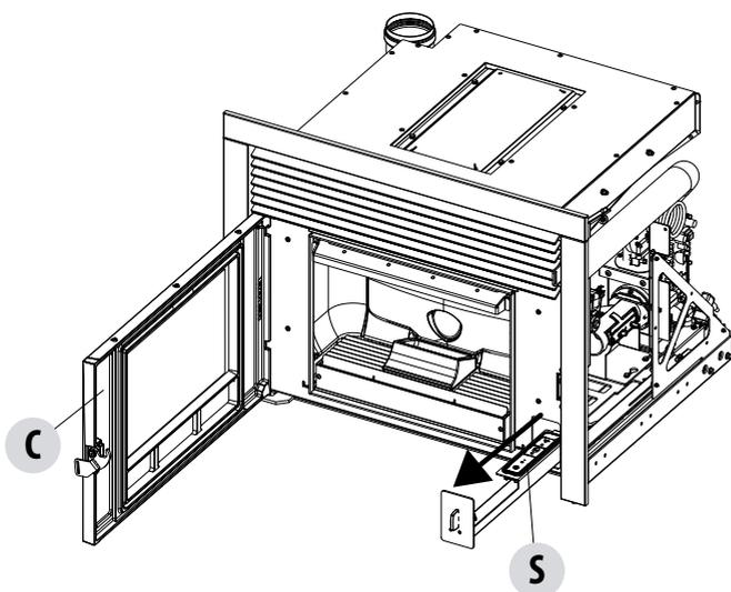
Operazione necessaria per resettare l'elettronica dopo un messaggio di errore.
