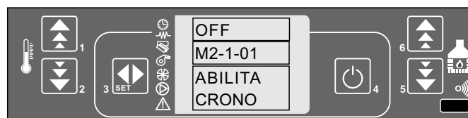
pannello comandi - abilitazione funzione cronotermostato
