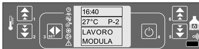
pannello comandi - modulazione temperatura impostata
