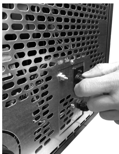
Fig. 33 - Riarmo manuale: MODO AIRTIGHT e QUASIMODO UP
