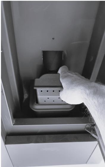
**Fig. 30 - Rimozione braciere**
