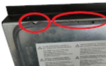
Fig. 24 - Guarnizione deteriorata
