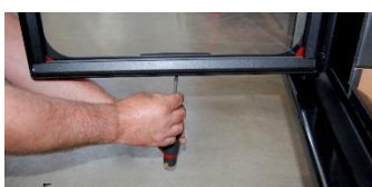
Allentare le viti di fissaggio e rimuovere il fermavetro inferiore
