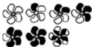
Visualizzazione stato del ventilatore/dei ventilatori.
