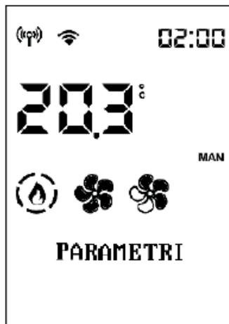
Si entra nei Parametri con il tasto
