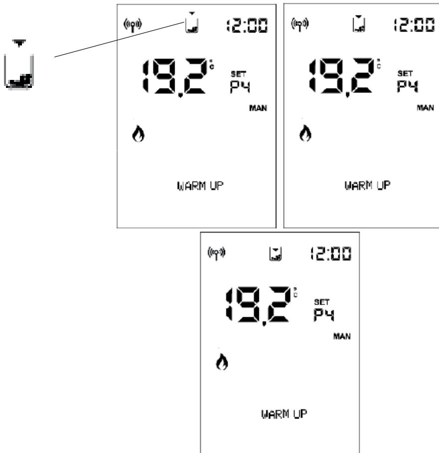
Le frecce si accendono in sequenza indicando la necessità di caricamento.
