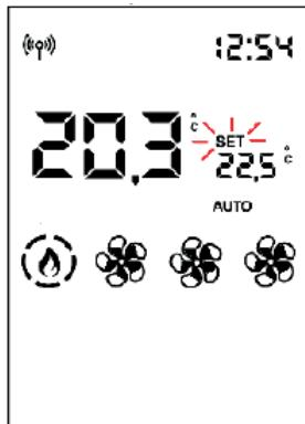
Dopo aver impostato la temperatura ambiente di installazione (o con la potenza ambiente in manuale), se si lascia passare 5" senza pressione di tasti, smette di lampeggiare la scritta SET ed si esce dalle impostazioni.
