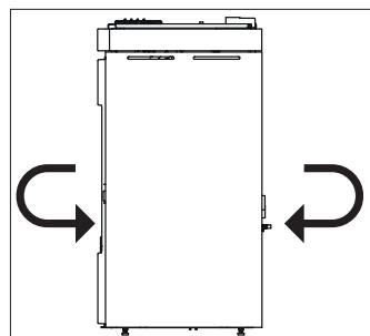
1. **A fianchi già tolti per togliere la stufa dal bancale, montare le due piastrelle laterali** alla staffa di fissaggio del fianco utilizzando le viti e rondelle in dotazione.
