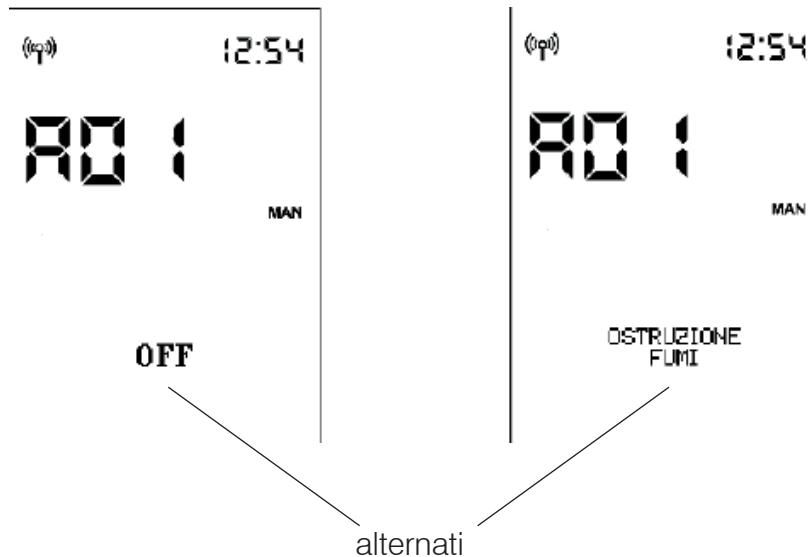
In caso di allarme al posto della temperatura ambiente viene visualizzato il codice allarme.
