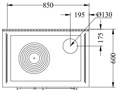
Versione con uscita fumi a destra. La versione con uscita fumi a sinistra è simmetrica.
