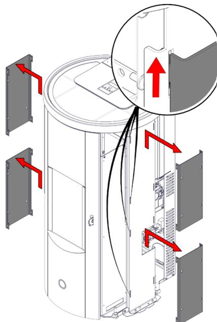
1) Smontare le piastre di fissaggio
