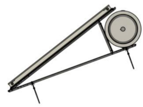
EVO series Struttura con supporti distanziati M12 X 350 mm
